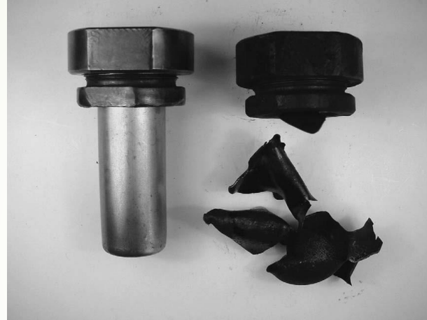
50% wet HOBt Koenen-test 2mm
